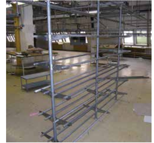
147. Prvi "prototip" knjižnega regala, izdelanega iz kovinskih elementov tračnega sistema.
